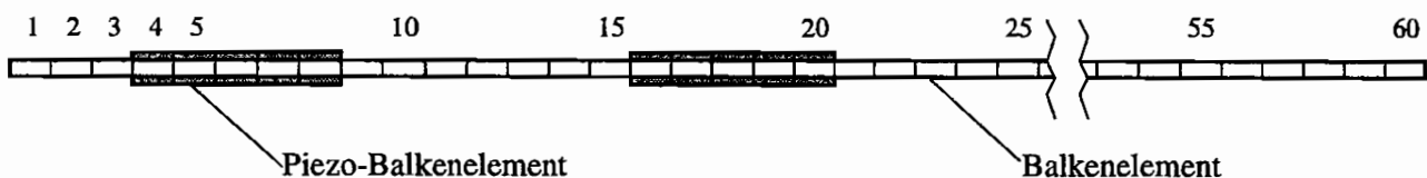
Abb. 7.7: FE-Modell des Versuchsbalkens
