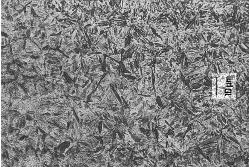
Abb. 5.29: Schliffbild einer martensitischen Probe, ölgeschreckt
