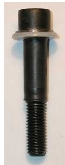
Abbildung 4.6: Isolierung der Schraube
